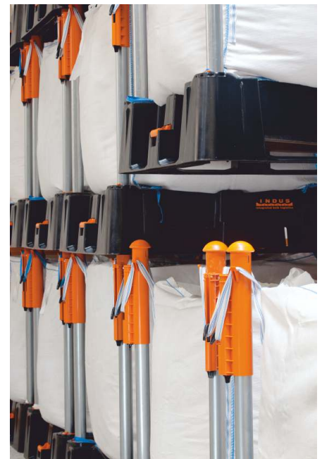
Die maximale Lagerkapazität (3 Big-Bag Gestelle NEVA) beträgt 6 m 3 oder 6'000 kg pro 1.4 m 2 .
